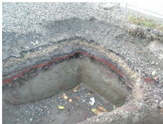
Vue d'une couche de terre polluée rouge
