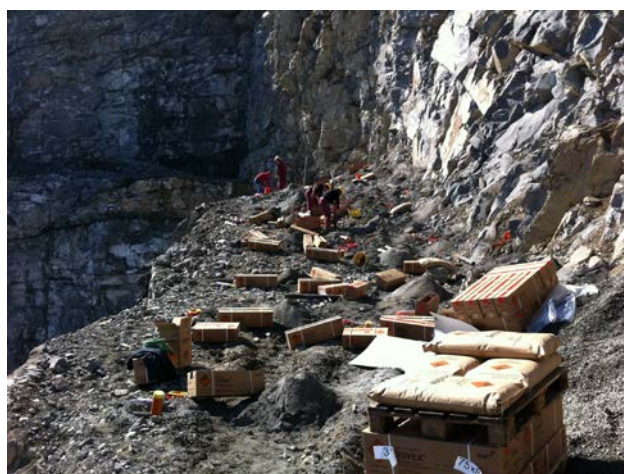
Préparation d'un minage à la carrière des Freneys
